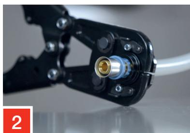
Colocá la pinza en posición y apretá hasta el final del recorrido... ¡Y listo!
